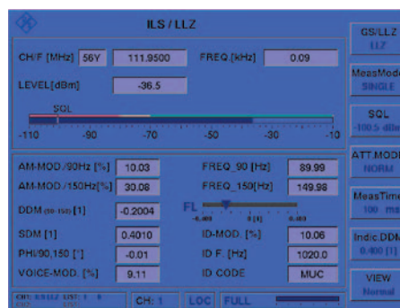
Рис. 26. Анализатор R&S®EVS300: статистический анализ сигналов ILS-LOC/LLZ при помощи кабинного столбчатого индикатора «лети левее/правее» для параметра DDM
