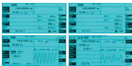
Рис. 19. Генерация и анализ сигналов VOR, ILS и MB в приборе R&S®CMS57
