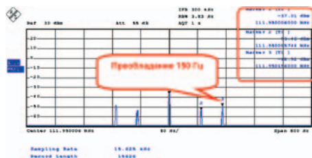
Рис. 17. Опция аналоговой демодуляции R&S®FS-K7: ВЧ-спектр сигнала ILS с несущей и преобладающей частотой 150 Гц
