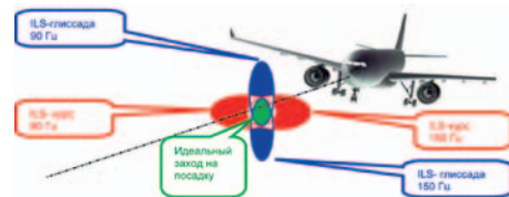
Рис. 5. Навигация при заходе на посадку с использованием системы инструментальной посадки (ILS)
