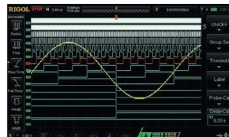
Рис. 4. Экран осциллографа MSO1000Z с одновременным включением 16-ти цифровых и одного аналогового канала
