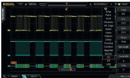
Рис. 10. Экран осциллографа RIGOL в режиме выбора запуска по шине I<sup>2</sup>C
