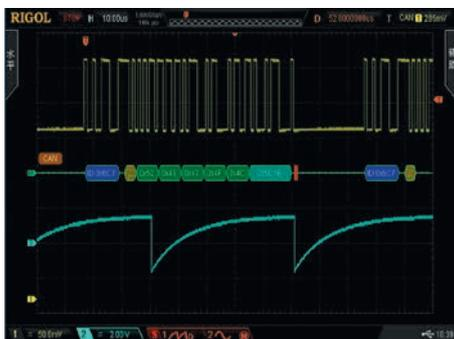
Рис. 6. Экран осциллографа MSO/DS2000A в режиме декодирования сигналов шины CAN
