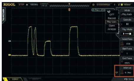
Рис. 8. Иллюстрация отображения перехода на следующую страницу пользовательского меню
