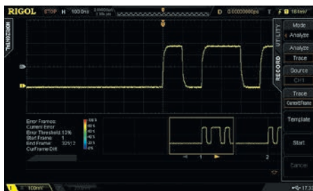
Рис. 10. Первоначальный вид экрана при включении функции анализа сигнала
