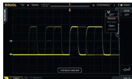
Рис. 4. Вид экрана при активации покадрового регистратора
