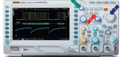
Рис. 3. Органы управления регистратором осциллографа Rigol серии MSO/DS2000A
