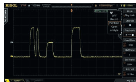
Рис. 7. Экран осциллографа при включенной функции воспроизведения
