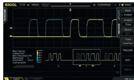
Рис. 11. Установка первого кадра в качестве шаблона при анализе сигналов
