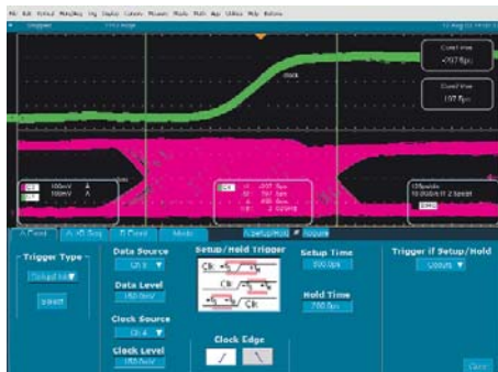
Рис. 4. Захват рассогласованных логических переходов относительно тактового импульса
