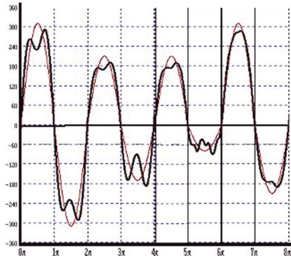
Рис. 2. Непериодическая полисингулярная кривая напряжения
