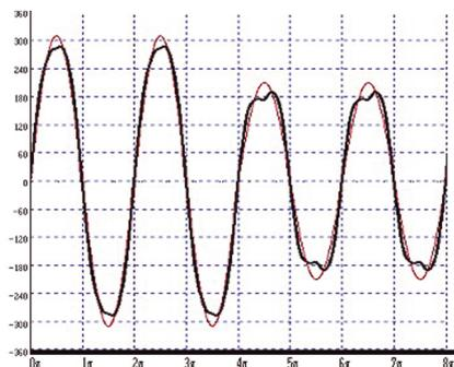
Рис. 1. Периодическая полисингулярная кривая напряжения
