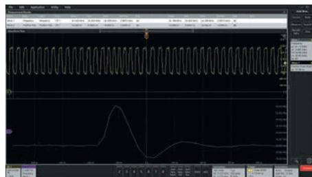
Рис. 11. Дальнейший анализ этого генератора тактовой частоты с помощью запуска по длительности импульса показал, что контроллер ФАПЧ периодически сбрасывался
