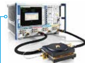
Измерение параметров пленок на основе резонатора
