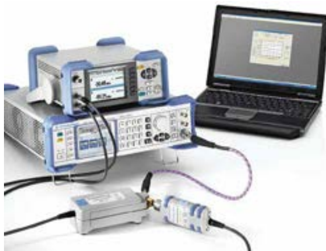
Измерительная установка для калибровки преобразователя мощности NRP-Z55
