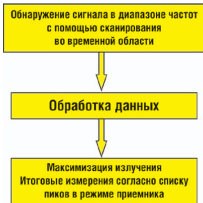
Рис. 1. Оценка соответствия требованиям к ЭМП с использованием сканирования во временной области в случае, если стандарты изделия не ссылаются на стандарт CISPR 16-1-1:2010 и его поправку 1:2010
