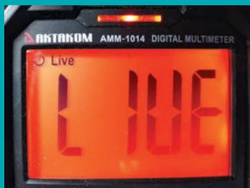
Определение фазного проводника мультиметром АММ-1014
