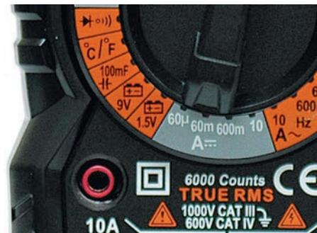
Рис. 12. Режим тестирования батарей на поворотном переключателе АММ-1014
