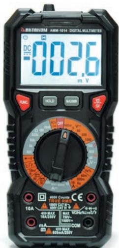
Рис. 9. Мультиметр АММ-1014
