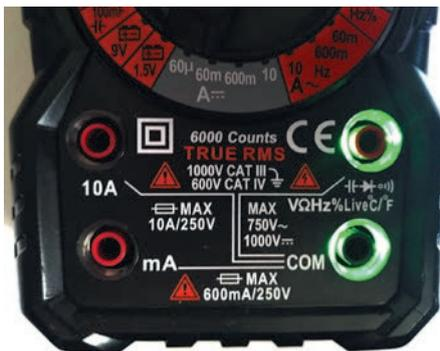
Рис. 10. Подсветка гнезд измерительных проводов мультиметра АММ-1014
