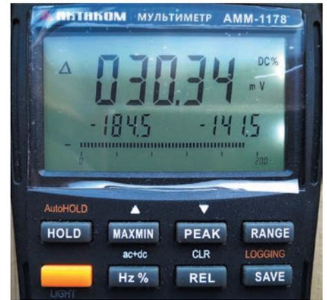
Рис. 7. Функциональные клавиши и дисплей АММ-1178 в режиме относительных измерений (значок % на экране — разность между опорным и измеренным значениями выражена в процентах)
