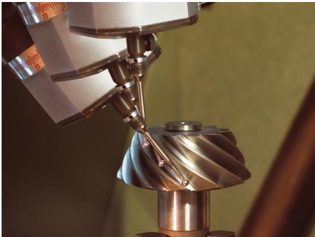
Измерение поверхности зуба шестерни
