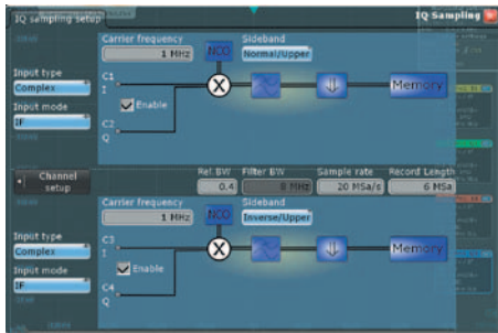
Рис. 6. Комплексные сигналы с квадратурной модуляцией в нижнем ПЧ диапазоне
