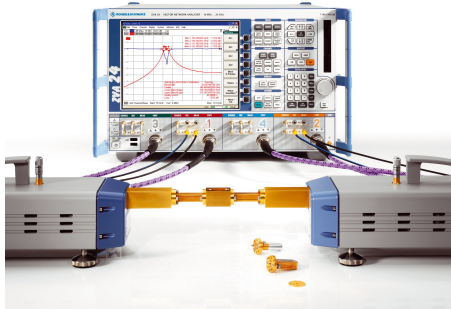
Рис. 3. Полная схема измерения полосового фильтра на 90 ГГц с калибровочным волноводным набором R&S ZV-WR10
