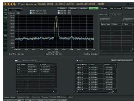
Рис. 33. Отображение режима детектирования пиков и создания таблицы пиков в программном обеспечении Ultra Spectrum
