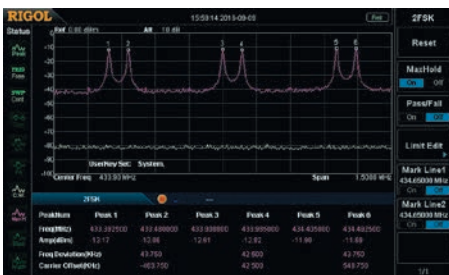
Рис. 31. Захват сигнала с классической частотной манипуляцией 2FSK
