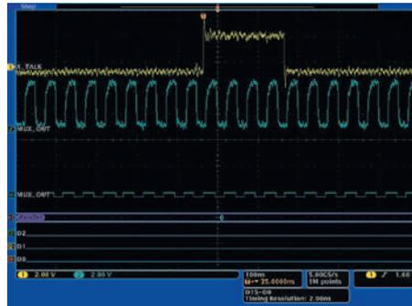
Рис. 6. Аналоговые сигналы и декодированные данные параллельной шины
