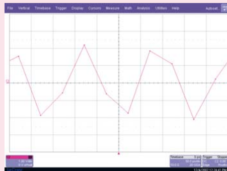
Рис. 5. Искажение синусоидального сигнала 6 ГГц-дискретизация 20 ГГц в режиме линейной интерполяции (LeCroy 8600A)
