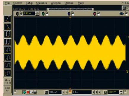
Рис. 16. Отображение сигнала с амплитудной модуляцией на обычном цифровом осциллографе
