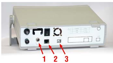
Рис. 2. Задняя панель АСК-3106 (с интерфейсом Ethernet): 1 — разъём питания 5,5...7,5 В, 2 — разъём RJ-45 Ethernet, 3 — разъём USB-порта (типа «USB-B»)
